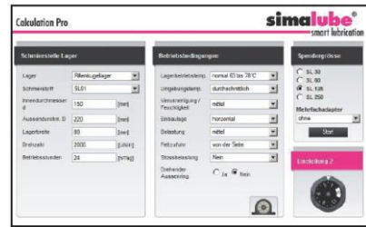
使用“Calculation Pro” 計算選擇合適容量的注油器和注油時間的設定
