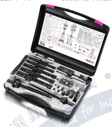
本雙拆卸工具箱 TP150 專業用於拆卸深溝滾 珠軸承和油封密封圈。無論安裝在套筒內或 軸上的軸承,藉助此工具同樣可以快速精準 的拆出。TP150 也可用於拆卸密封圈,它是 一種獨特而專業的拆卸工具。
