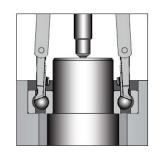
將拉馬爪鎖扣在軸承滾道中及固定支撐絲桿,然後 轉動支撐絲桿就可拆出軸承。
