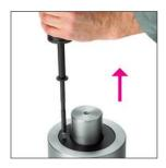
使用滑動錘敲擊 3 下,將自攻拆卸螺絲擊入密封圈內 2~3 個 牙只為便於擰入; 然後順時針方向轉動滑動錘手柄數圈, 把 自攻拆卸螺絲完全擰到底;再使用滑動錘反向滑動敲擊,即 可輕易拆出密封圈。
