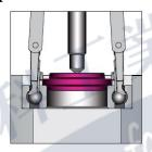
套筒墊片可發揮實心軸的功能,把拉馬爪和支撐絲 桿組合後緊扣固定到位,配合反向滑動錘可輕鬆拆 出處於套筒內的軸承。(此時不可轉動支撐絲桿)
